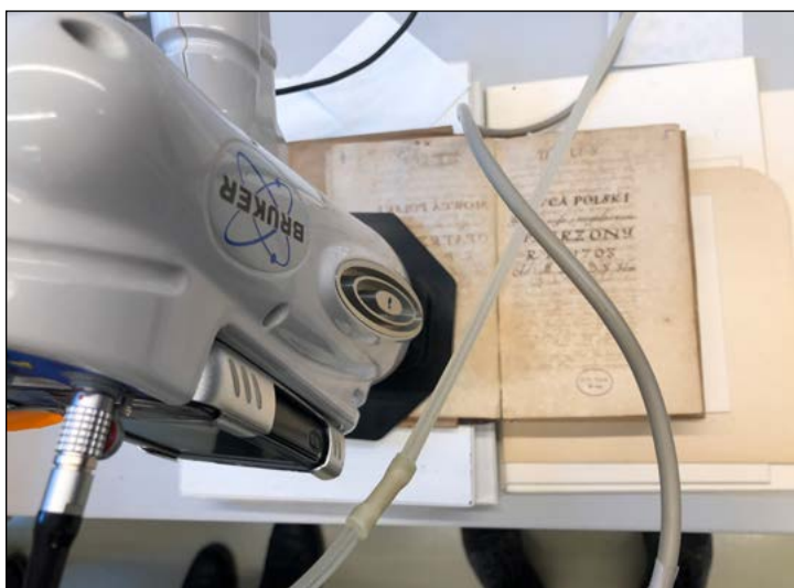
Ręczny spektrometr XRF w trakcie badania rękopisu ze zbiorów BUW (fot. B. Wagner)
